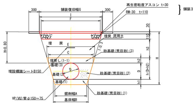
市道 (As舗装) (As舗装:土被りH=0.80m) 寸法表 単位:m
