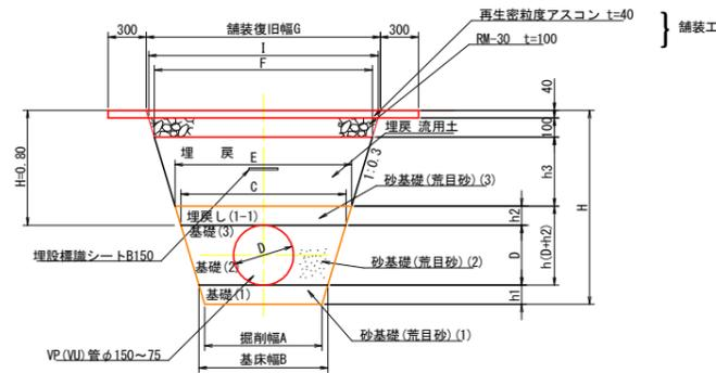
市道 (As舗装) [幅員<4m] (As舗装:土被りH=0.80m) 寸法表 単位:m
